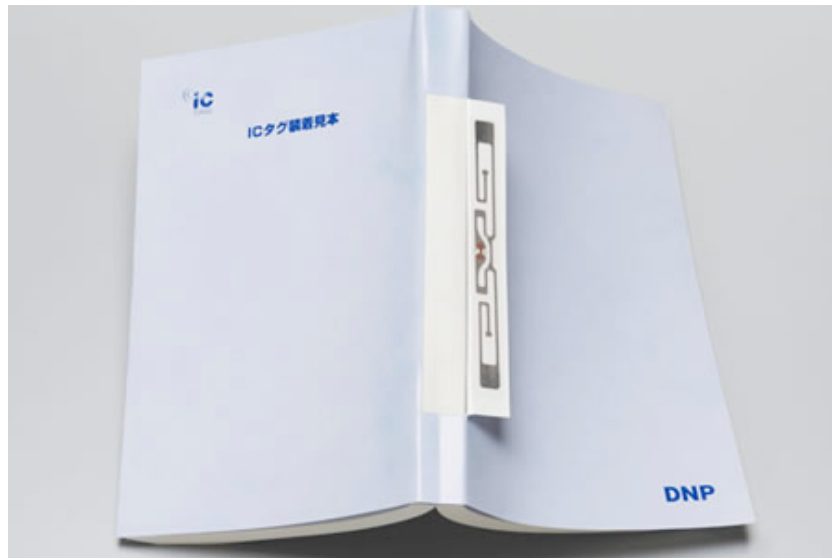
図2.1 書籍の背表紙の裏面に装着する書籍専用電子タグ
